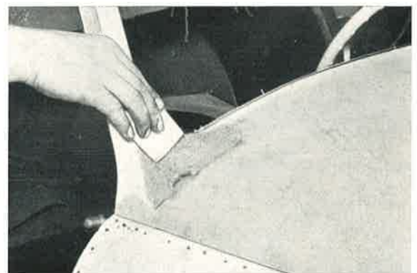
Bild 633: Mit dieser Holzkittmasse werden die Übergänge an Karosseriestößen ausgefüllert und richtig geformt.
