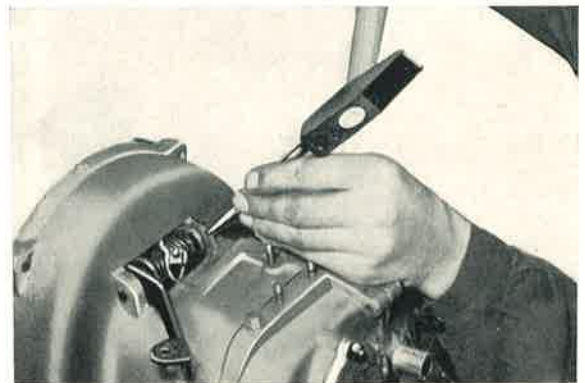
Bild 292: Bevor man den Bolzen für den Kupplungshebel ausbauen kann, muß der Spannstift entfernt werden.
