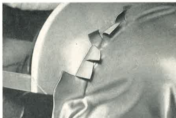
Bild 652: In Längsrichtung über die runden Stellen gespannte Stücke werden auch in Querrichtung gespannt.
