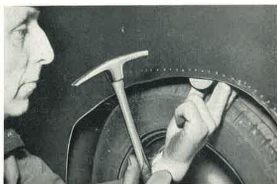
Bild 654: Zunächst nur angeheftete Nägel werden an federnden Stellen durch Gegenhalten eingeschlagen.
