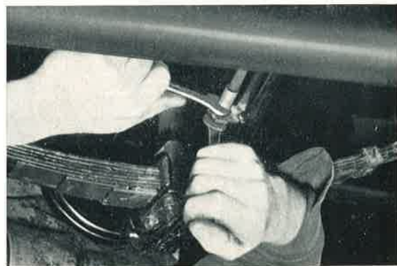
Bild 353: Bei Fahrzeugen mit hydraulischer Bremse wird die Bremsleitung am Schlauchstück gelöst.
