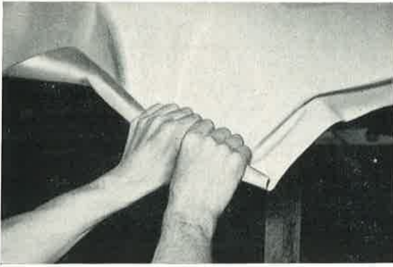
Bild 661: Beim Dachbezug ist Vorbedingung für einwandfreien Sitz gutes Vorspannen u. Anheften an den Bogen.
