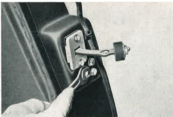
Bild 763: Mit den unteren drei Schrauben ist die untere Scharnierhälfte in der Kastensäule befestigt. Türhalteband, Gummipuffer u. die Sperre sind gut zu erkennen.
