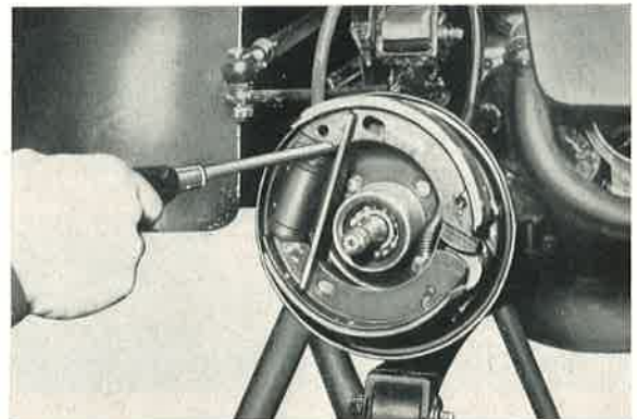
Bild 413: In gleicher Art werden die Bremsbacken von der Auflage am Bremszylinder mittels Hebel herausgehoben.
