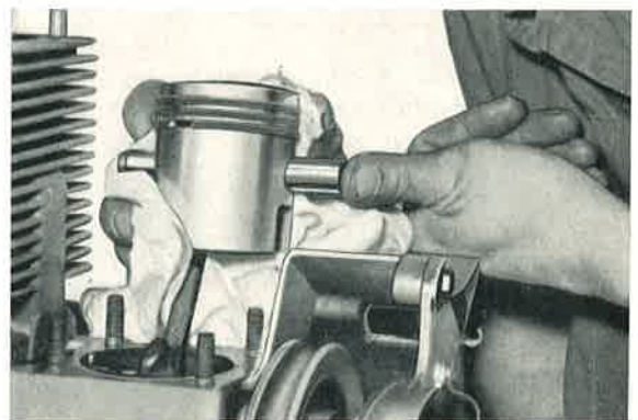
Bild 154: Dieses Bild zeigt den Einbau des Kolbenbolzens in einen auf 60° C erwärmten Kolben der älteren Bauart.
