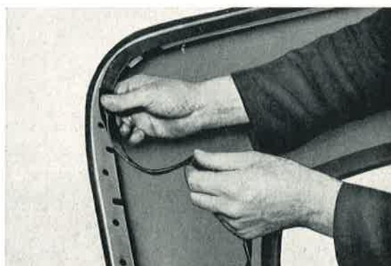
Bild 734: Auch am Seitenteil ist eine fugenlose Verlegung des plastischen Bandes für die spätere Wasserdichtigkeit der Karosserie von großer Bedeutung.
