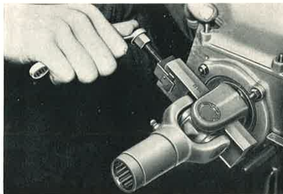
Bild 32a/4: Kreuzgelenke mit Kerbkonusverbindung werden mit Spezial-Abzieher WO 23 gelöst. Vorrichtung nur mäßig anziehen und Lösen des Konussitzes durch leichten Schlag mit Gummihammer unterstützen.
