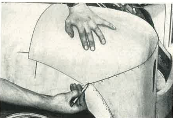
Bild 624: Links das Kreuz, nach dem man die aufgelegte Holzabdeckung zunächst zum Schneiden anzeichnet.
