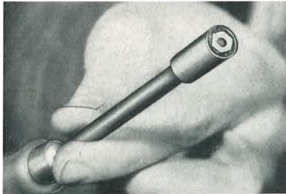
Bild 723: Zum Festdrücken der Federmuttern kann ein Steckschlüssel verwendet werden, der wie auf dem Bild gezeigt, durch eine eingekittete Mutter vorbereitet ist.
