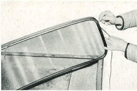
Bild 781: Mittels eines geeigneten Werkzeuges (Falzbein etc.) wird der Bindfaden wie beschrieben eingedrückt.
