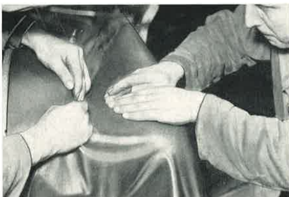
Bild 643: Dann werden die vorgewärmten Stellen durch Streichen mit der Hand u. Ziehen durch Helfer angelegt.
