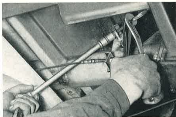
Bild 471: Bei Verschmutzung der Bremsstangengewinde muß beim Nachstellen der Bremse das Bremsseil mittels einer Wasserpumpenzange festgehalten werden.
