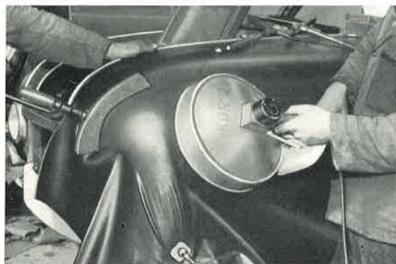
Bild 642: Überall dort, wo der Bezugsstoff jetzt gespannt wird, ist er mit einer Heizsonne gut vorzuwärmen.
