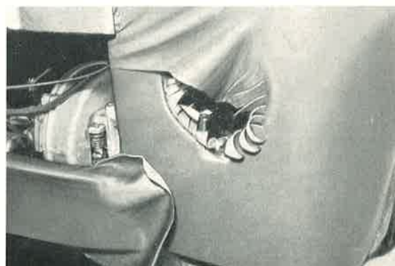
Bild 653: Besondere Sorgfalt erfordert der Lampenausschnitt. Das Spannen erfolgt mittels der Spannzangen.
