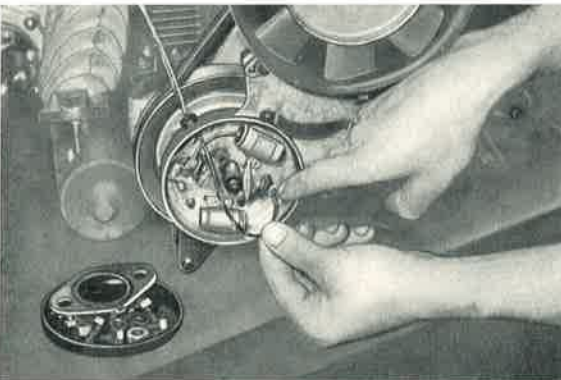
Bild 123: Die Primärkabel der Zündung sind im Zündverteiler nur eingeklemmt und werden durch Niederdrücken der Federn frei und herausgezogen.
