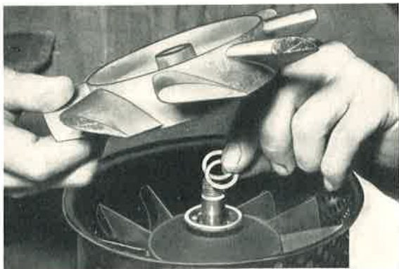
Bild 221: Wird nach Bild 214 Untermaß gemessen, können zwischen der Nabe des Laufrades und dem Nilos-Ring im Gehäuse Stahl-Scheiben beigelegt werden.
