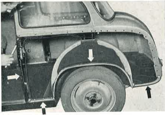
Bild 741: Vor Anbau d. Seitenteils ist Rahmen u. Radkasten an den mit Pfeilen markierten Stellen vorzubereiten.
