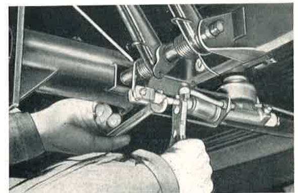
Bild 494: Durch Verdrehen der Druckstange ist Fußhebelgestänge so einzustellen, daß zwischen Druckstange und Kolbendruckpfanne etwa 1 mm Spiel vorhanden ist.
