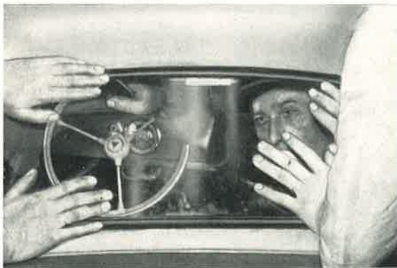
Bild 583: Drei Mann sollen gemeinsam arbeiten, um mit Druck die Scheibe an allen Stellen richtig anzusetzen.
