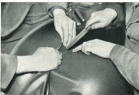
Bild 644: Die so gespannten Teilstücke werden nun mit Nägeln geheftet und dann ringsum richtig befestigt.
