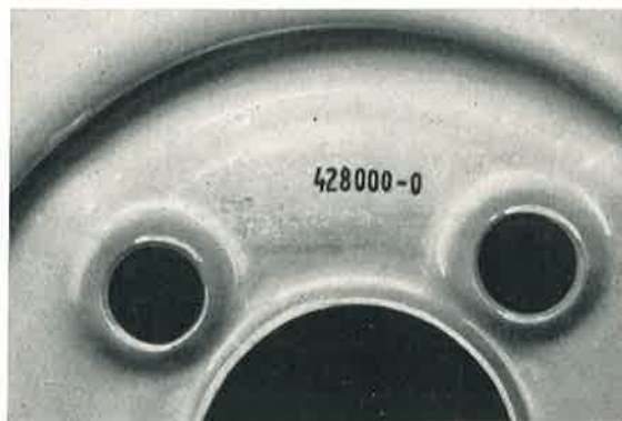
Bild 52a/1: An dieser Stelle der Felge sind die neuen Scheibenräder mit d. Ersatzteil-Nummer gekennzeichnet.
