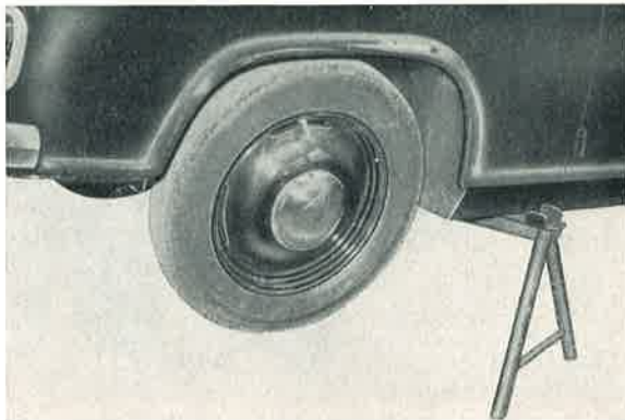
Bild 352: Der Untersetzbock wird bei Arbeiten an der Hinterachse schräg unter den Kastenholm gesetzt.
