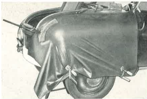
Bild 641: Der Bezugsstoff wird zunächst aufgelegt, allseitig glattgezogen und mittels Zwingen vorgespannt.
