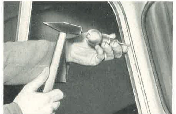
Bild 592: Die Löcher für die Schraubnägeln werden zunächst zweckmäßig mit der Ahle vorgeschlagen.
