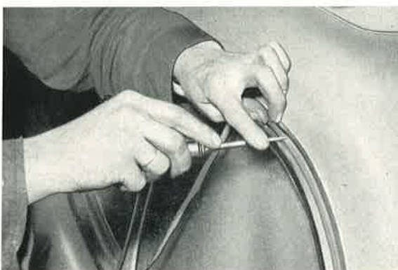
Bild 604: Das Rillenband wird zügig zur Abdeckung der befestigten Nägel in die Regenleiste eingebracht.
