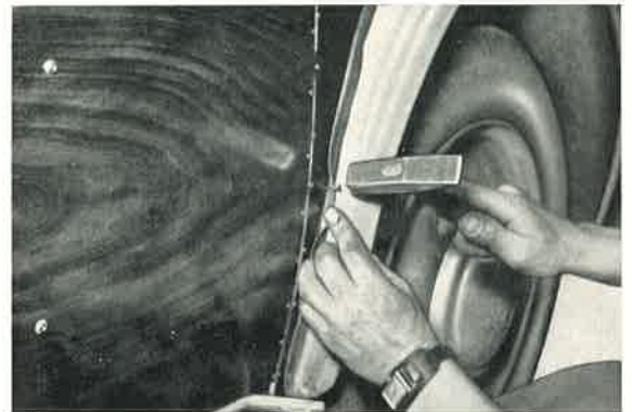
Bild 572: Nägel werden mit dem Hammer nur angeheftet, damit beim Einschlag keine Beschädigungen entstehen.
