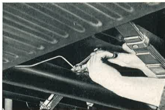
Bild 354: Bei allen Fahrzeugen, bei denen der Verteiler vor der Hinterachse montiert ist, muß dieser gelöst und das Verteilerstück herausgedrückt werden.
