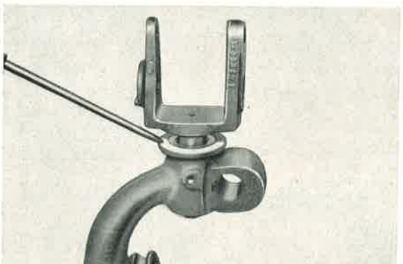
Bild 424: Der Filzdichtring, zweckmäßig mit Talg getränkt, muß überall glatt in seiner Fassung anliegen.
