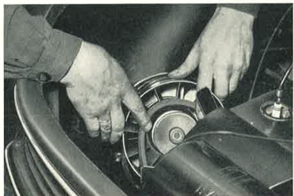
Bild 244: Erst Keilriemen auflegen, dann Gehäuse ankippen und Gehäusestift in das Loch im Bock einsetzen.
