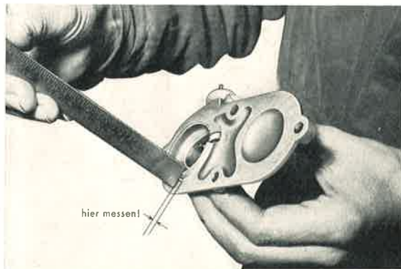
Bild 32 e/3: Da der Bund am Gehäusedeckel nicht bearbeitet ist, können kleine Unterschiede in der Höhe des Bundes vorkommen. Vor Zusammenbau messen!
