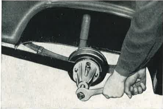
Bild 362: Zum Abziehen d. Bremstrommel wird d. Halteschlüssel an der hinteren Radkastenseite abgestützt.
