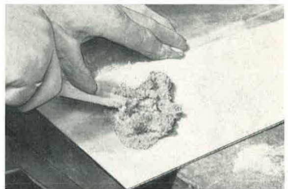
Bild 632: Holzkitt wird aus Sägespänen und Leim ange- rührt und zu einer streichfähigen Masse verrührt.
