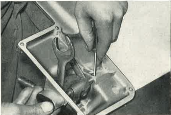
Bild 343: Wieder müssen beim Durchschieben der Schaltstange Kugel u. Feder mit Dorn niedergedrückt werden.
