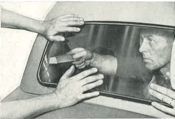
Bild 582: Unter ständigem flachen Andrücken mit der Hand wird von innen die Gummilippe mit Falzbein angehoben.
