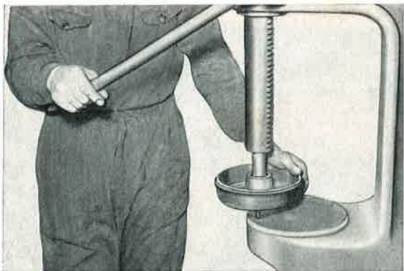
Bild 363: Das Herausdrücken d. Kugellager aus d. Nabe soll, soweit möglich, mit einer Presse durchgeführt werden.
