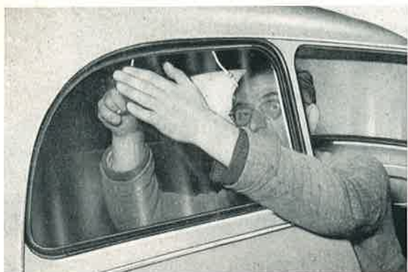
Bild 784: Beim Abziehen des Bindfadens wird mit der anderen flachen Hand fest gegen die Scheibe gedrückt.
