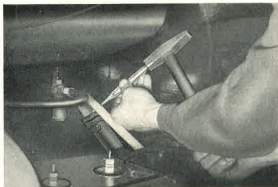
Bild 253: Die Spannstifte für die Lenksäule u. die Schaltstange werden mit einem 4 mm Dorn herausgeschlagen.
