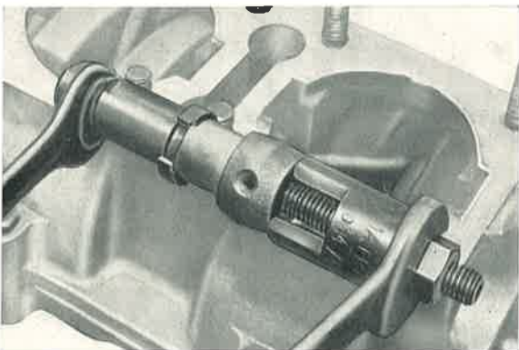
Bild 163: Beim Einziehen der neuen Pleuelbuchse darauf achten, daß die Buchse beim Ansetzen nicht verkantet.
