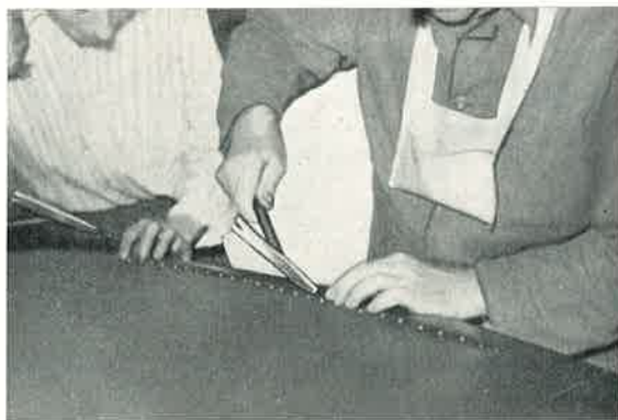
Bild 663: Der Ausschnitt für Schiebedächer wird erst seitl. in gespanntem Zustand genagelt, dann aufgeschnitten.
