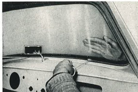
Bild 792: Während des Abziehens des Bindfadens wird mit der flachen Hand von außen fest gedrückt.
