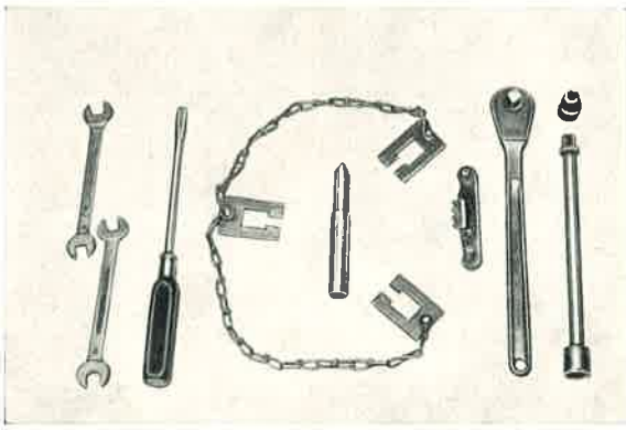
Bild 141: Zusammenstellung der Werkzeuge, wie sie für die Arbeit der Gruppe M, Motor, M 1 gebraucht werden.
