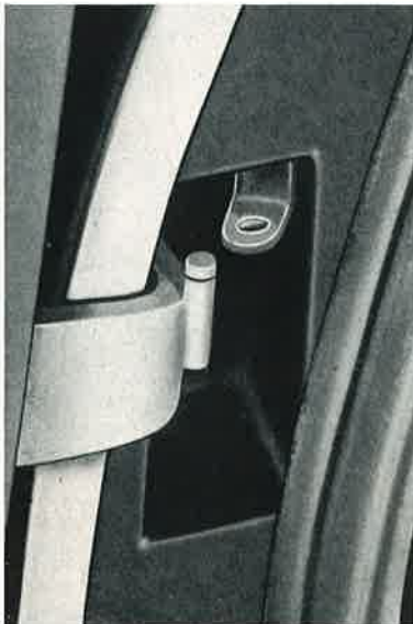
Bild 762: Das Türhalteband ist abgehoben und wird zurückgeschoben.
