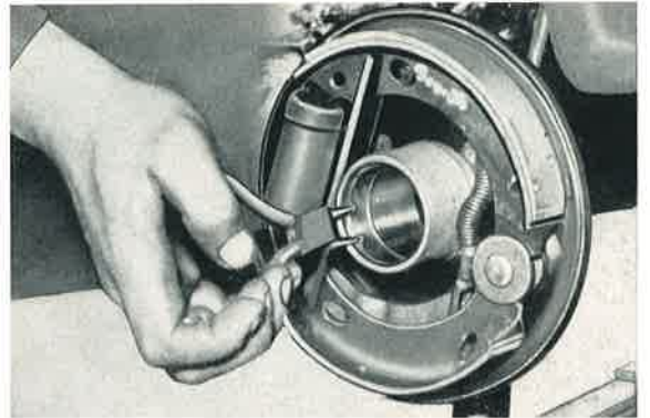
Bild 392: Die großen Seegerringe im Achsschenkel sollen nur mit einer Seegerring-Zange entfernt werden.
