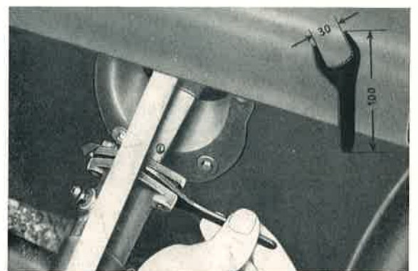
Bild 514: Die Lenkung kann selbstverständlich im Wagen nachgestellt werden. Zum Verdrehen der Exzenterbüchse benutze man einen flachen, kurzen Blechschlüssel.
