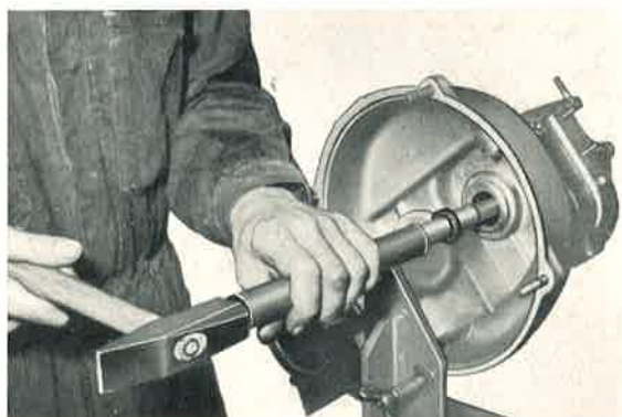
Bild 32 e/4: Damit die Dichtlippe des Abdichtringes durch die Kerbverzahnung nicht beschädigt wird, ist der Ring auf einer Schutzhülse zu montieren.
