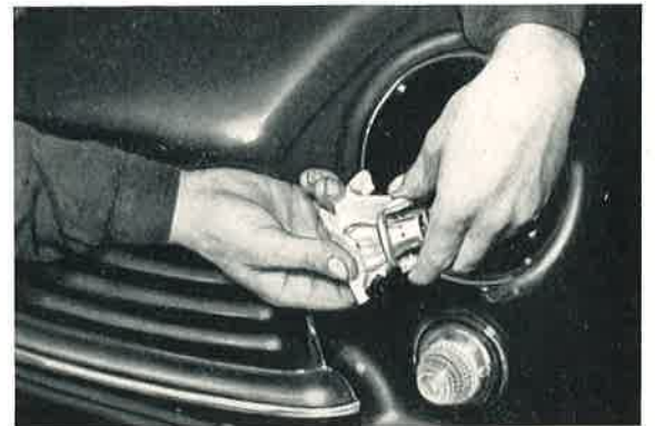
Bild 54 a/3: Glühbirnen sollen niemals mit bloßer Hand angefaßt werden, immer m. Tuch od. Papier umkleiden!
