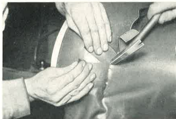
Bild 651: Wo größere Bogen sind, wird der Bezugstoff zwecks besseren Anliegens im Abstand eingeschnitten.
