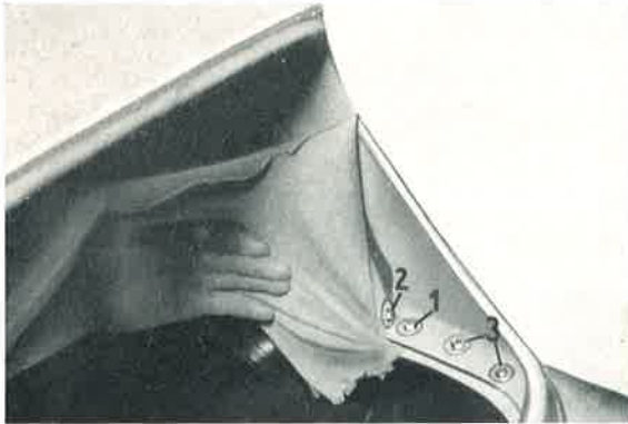
Bild 702: Das Festziehen der Schrauben in der bezeichneten Reihenfolge ist für eine gute Anlage zwischen Dach, Seitenfenster und Kofferheck von Bedeutung.
