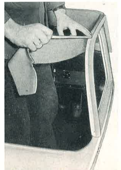
Bild 693: Wie beim Seitenfenster wird auch beim Kofferheck verfahren. Sorgfältige, fugenlose Verlegung des plastischen Bandes (z. B. Dekaplast) ist für spätere Wasserdichtigkeit von ausschlaggebender Bedeutung.
