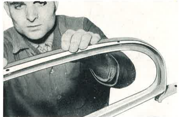
Bild 692: Plastisches Band wird so auf die Außenkante des Seitenfensters verlegt, daß die Lochreihe halb überdeckt wird. Wichtig ist, daß keine Trennfugen entstehen.
